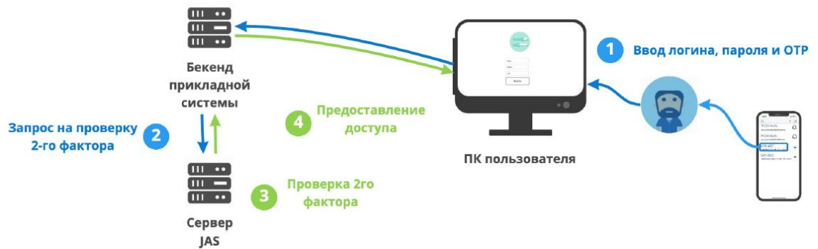
Рисунок 2 – Сценарий аутентификации с использованием одноразового пароля
