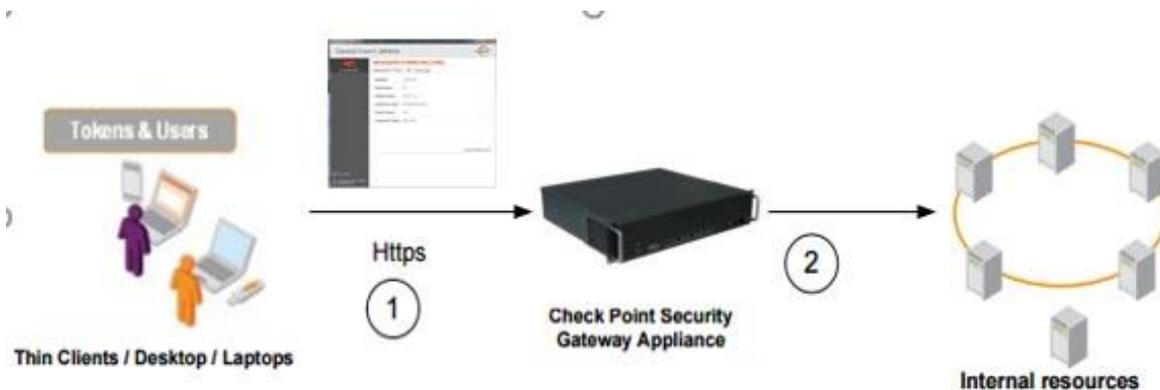
Пользователь соединяется с Check Point Security Gateway Appliance при помощи клиентского приложения Check Point Security Gateway. Пользователь вставляет токен JaCarta PKI, на котором расположен его сертификат, вводит PIN-код токена.
